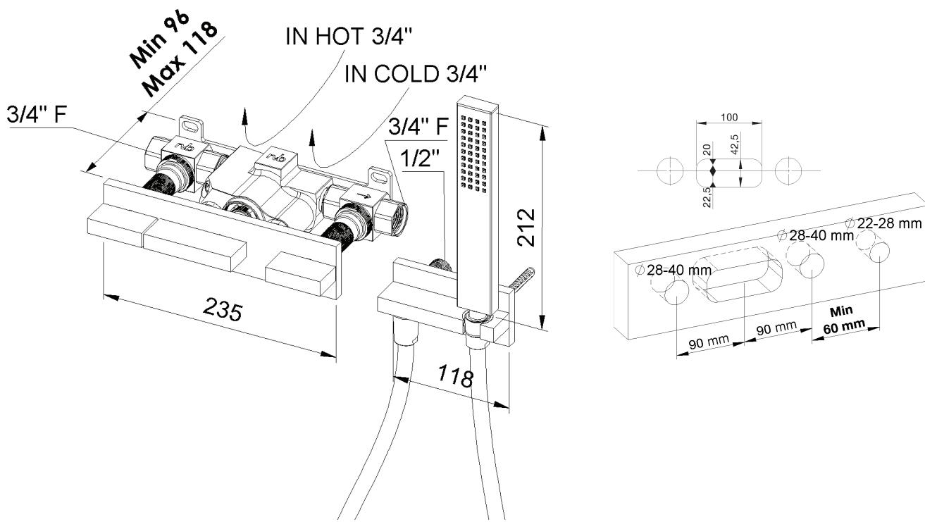
**Encastrement:** La plaque de fixation doit être fixée parallèlement au mur fini
